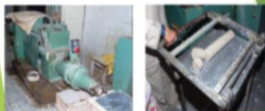
Из такой машины выходит "колбаса" фарфорового теста
